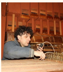
Ettore Bastici mentre controlla la pressione in un somiere
